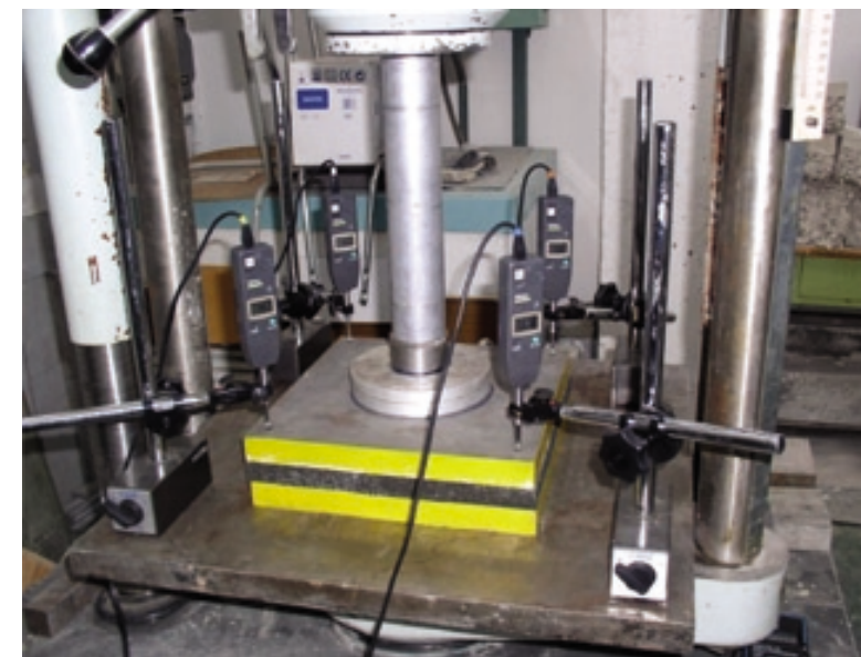
Měření statické plošné tuhosti vzorku antivibrační rohože
