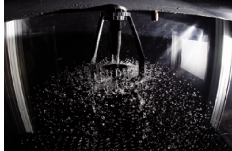
Na obr. vlevo detail rozstřiku trysky v chladicí věži, vpravo vizualizace proudění v napojení bypassu
