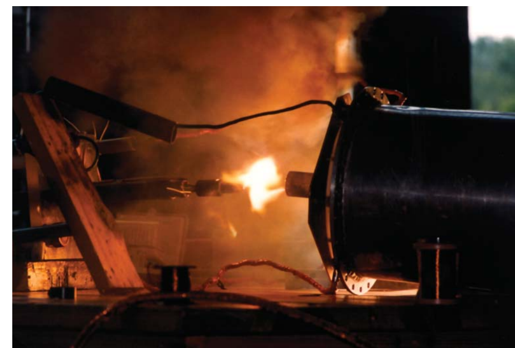
Výboj simulující bleskový výboj realizovaný v bleskové zkušebně Institute Plasma Physics and Laser Microfusion (IPPLM) ve Varšavě, při němž protéká elektrický náboj 100 coulombů.
