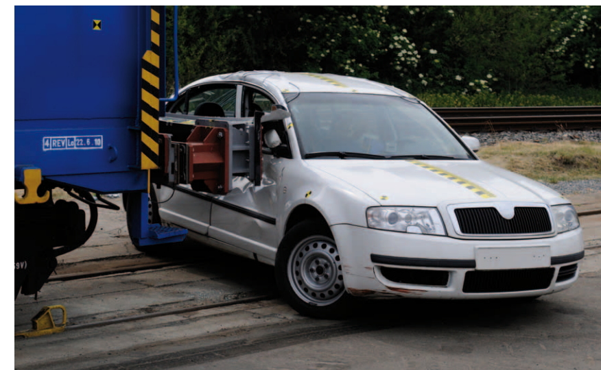
Crash-test střetu tramvaje (reprezentované zkušebním vagonem vybaveným čelníkem tramvaje) a osobního automobilu [ Foto: archiv ústavu ]
