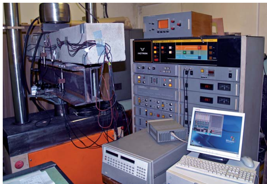
☛ Zkouška betonových nosníků předpjatých kompozity [ Foto: archiv autora ]
