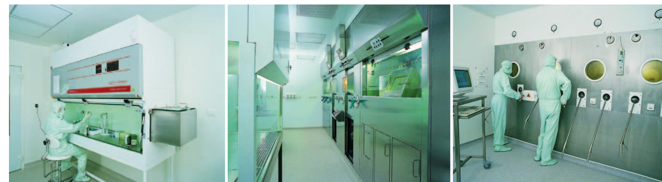
Ústav jaderné fyziky AV ČR v Řeži: Laminární box pro aseptické operace, polohorké komory pro výrobu SPECT radiofarmak a čisté prostory pro výrobu radiofarmak [ Foto: archiv ÚJF AV ČR ]
