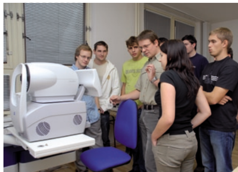
Laboratoř oční optiky – přístroj na snímku kombinuje funkce autorefraktometru, rohovkového topografu a aberometru
