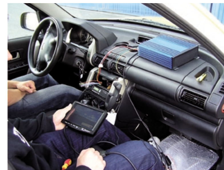
Vybavení vozidla, které umožňuje mít přehled o všech objektech pohybujících se po letištní ploše.
