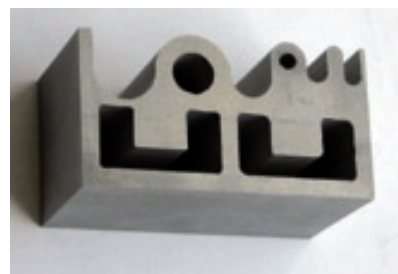
Výstupní strana řezu systémem AREM PRO. Materiál Al tloušťka 40mm
