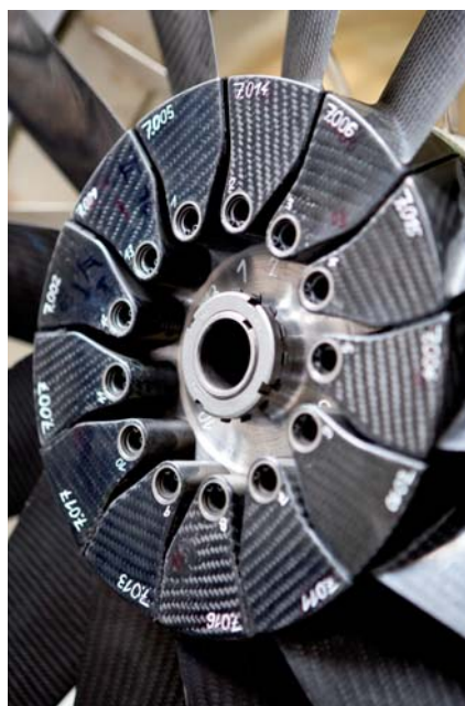
◀ Kompozitový rotor dmyhadla letecké pohonné jednotky [ Foto: Jiří Ryszawy ]
