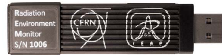
Osobní miniaturní online dozimetr pro astronauty na mezinárodní vesmírné stanici ISS. Dozimetr je miniaturizovaným detektorem Medipix, vyvinutým ÚTEF společně s CERN pro Univerzitu v Houstonu a NASA. [ Foto: archiv ÚTEF ]
