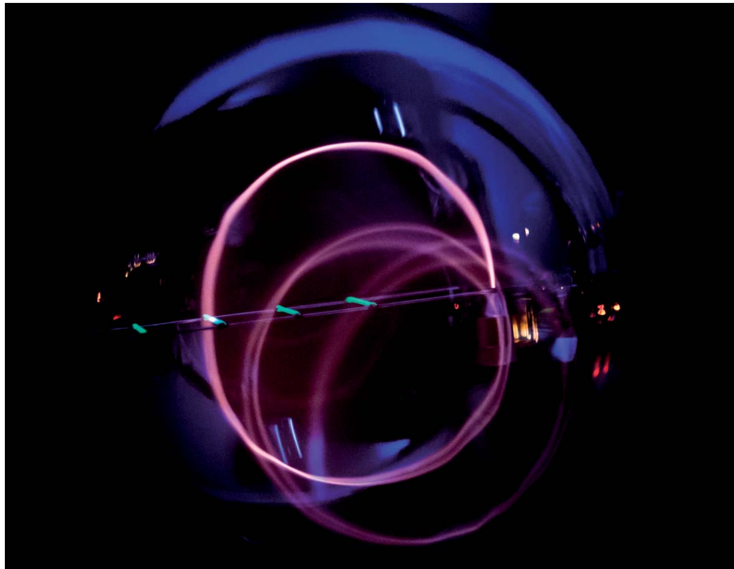
▮ Ohyb elektronového svazku v magnetickém poli (Katedra fyziky FEL)
