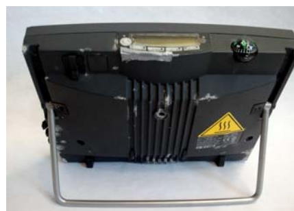
➤ Satelitní terminál Explorer 300 – znatelná oxidace hliníku
