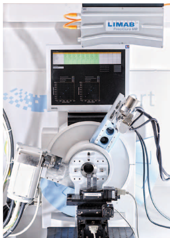
☛ Rentgenový difraktometr v laboratoři strukturní rentgenografie FJFI, který je doplněn o laserové měřidlo vzdálenosti s 5 μm přesností určení polohy analyzovaného povrchu a o systém polohování nezbytný pro určení struktury analyzovaných objektů. [ Foto: danvojtech.cz ]
